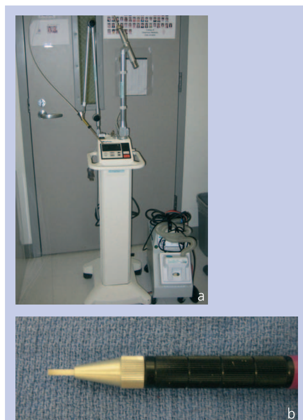
Figura 2a y b. Fuente y brazo de transmisión del rayo láser, y fuente de succión de gases (a); Punta de aplicación del rayo láser (b).
