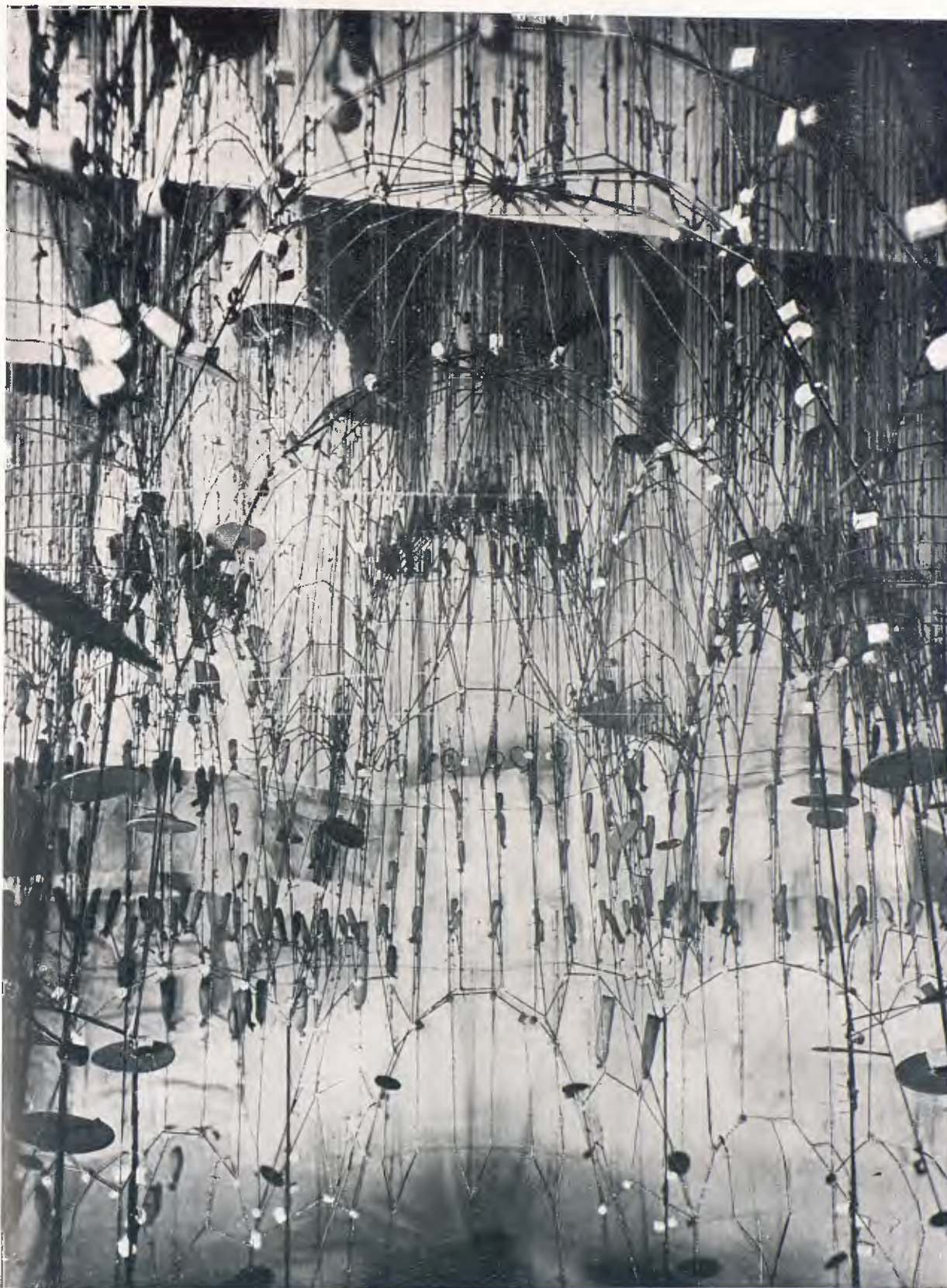
Funiculas que empleó Gaudí para el cálculo del templo de la Colonia Güell. Tal como se presentan, invertidas, dan la posición de sus arcos y bóvedas
