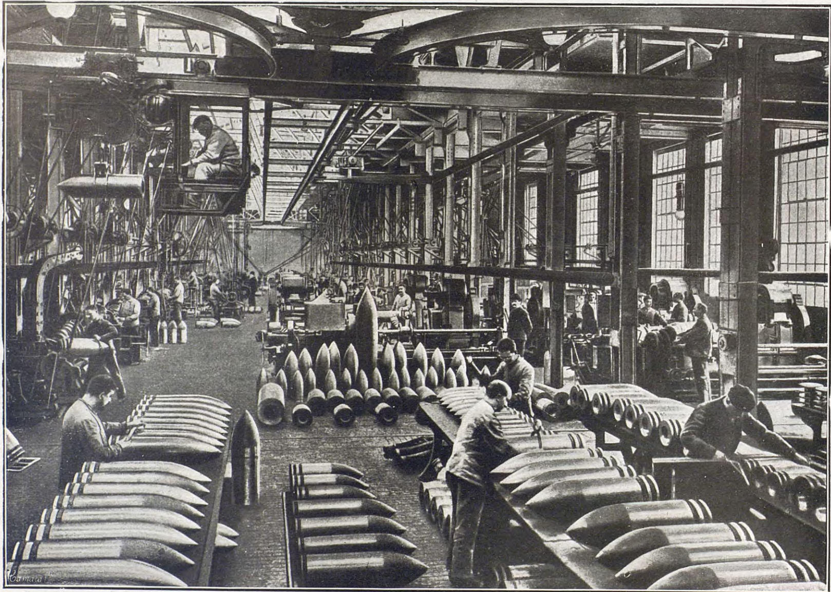
Uno de los talleres más interesantes de la fábrica Krupp Maquinaria para torneear proyectiles
