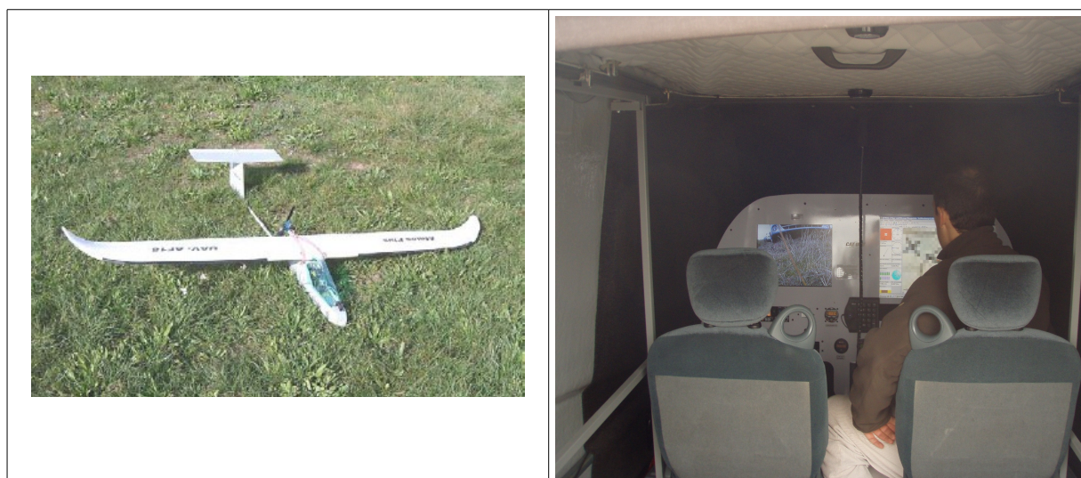
Figura 2. El miniUAV ATMOS-3 de CATUAV e interior de la cabina de control.
