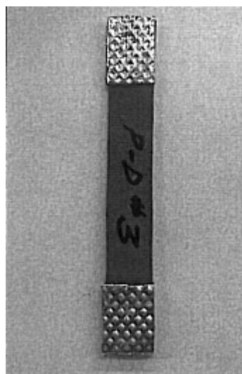
c) Ensayo de fibra impregnada con resina antes de su aplicación
