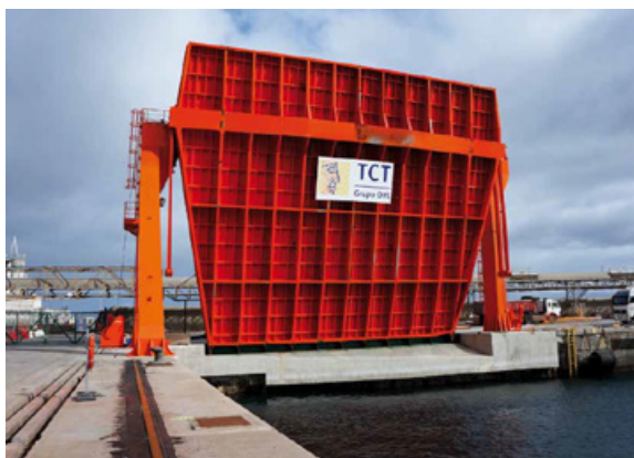
Innovadora rampa abatible para tráfico Ro-Ro de 20x25 m y una carga de servicio de 180 toneladas.
