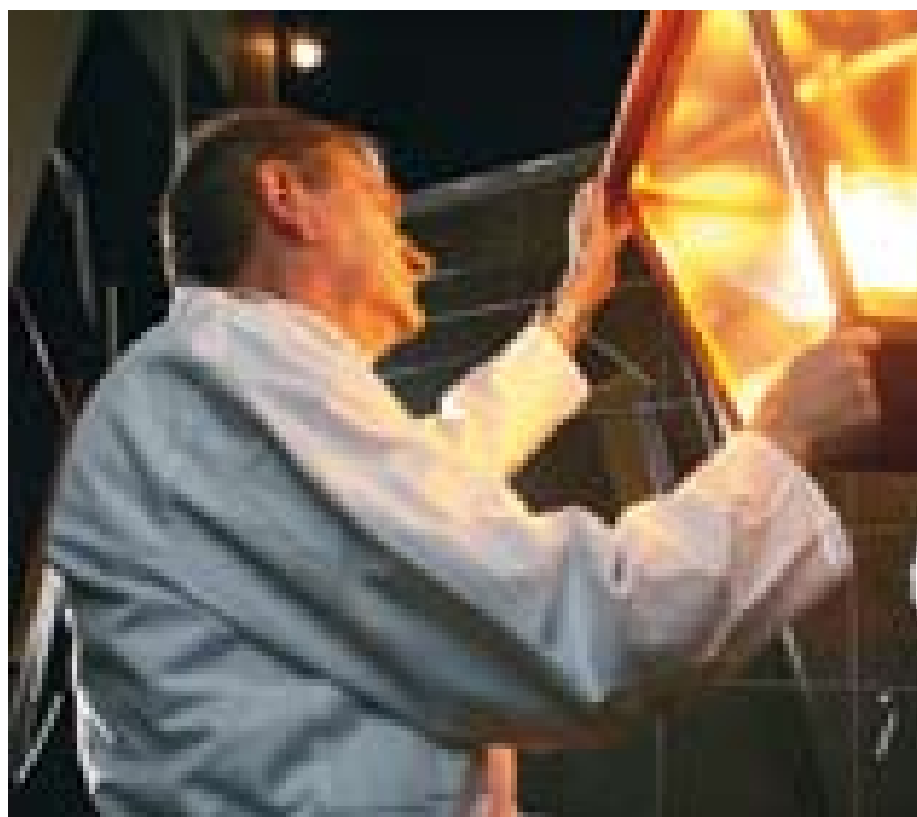
Mesure de luminaires au miroir tournant chez Laborelec - Belgique
