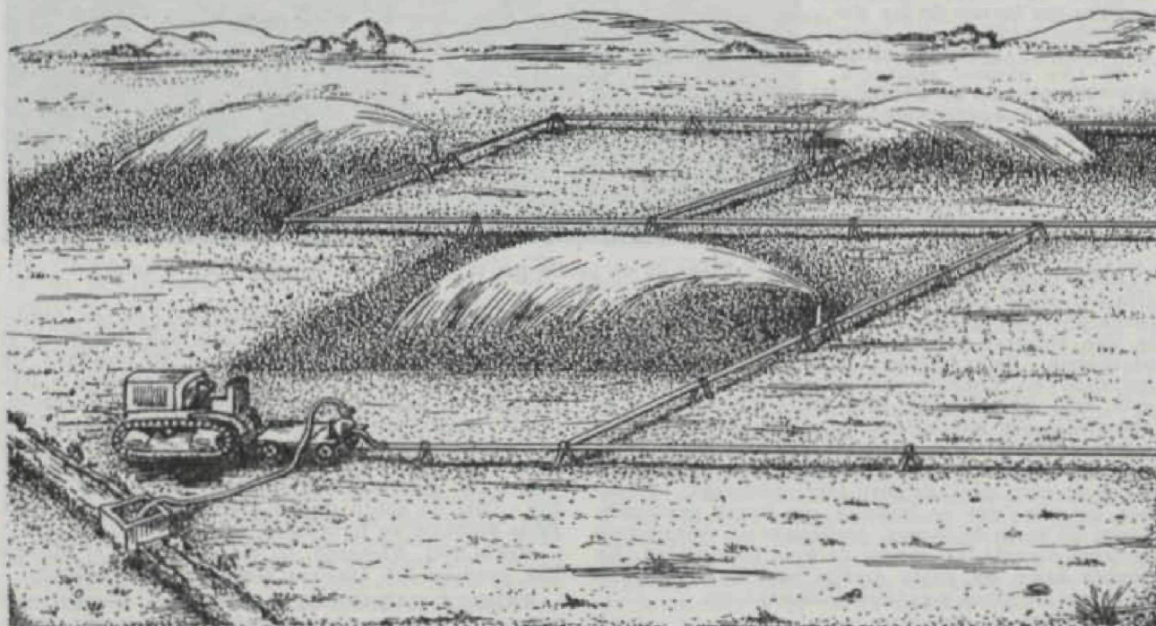
Disposición de un riego por aspersión aplicado a las grandes extensiones
