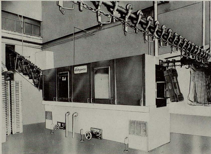
Lavadora lineal con dispositivo para adaptación de transporte aéreo de las cajas y traslado hasta el punto que se deseé. También se fabrica con cadena de arrastre propio.
