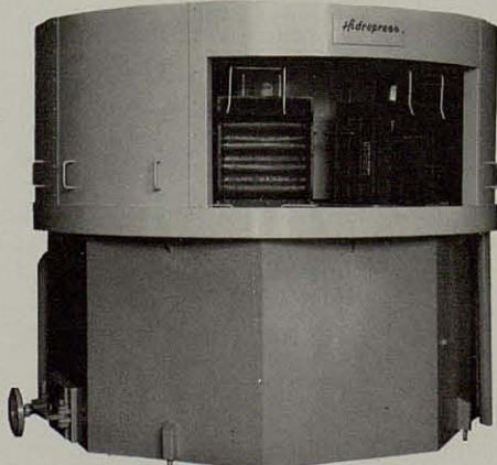
LAVADORA ROTATIVA para cajas de plástico de transporte de pollitos sacrificados, bandejas de incubadoras, cajas de transporte de pollitos de un día. Velocidad: 250 cajas por hora. Un sólo operario. Calentamiento del agua por vapor o con quemador de gasóleo.
