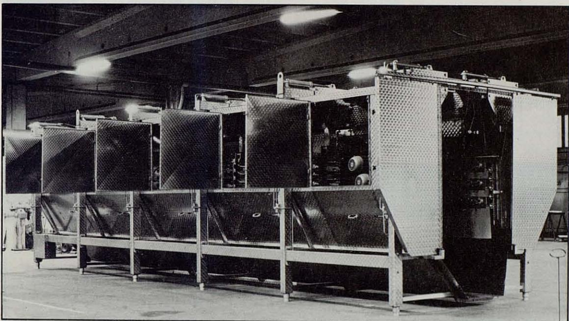
El Tren de Desplumado LINCO es modular -módulos compactos ajustables- y polivalente, puesto que permite la fácil sustitución de cualquiera de sus hileras, según el tipo de ave que se procese -broilers, pavos, etc. Su naturaleza compacta y cerrada permite mantener la temperatura del ave.
