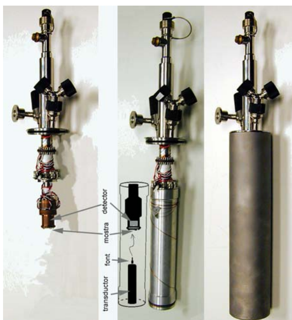
Fig. 4.16. El criostat de flux modificat conté el transductor, la font, la mostra i el detector al seu interior.
