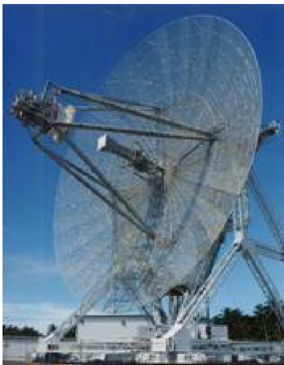
Una antena parabólica, utilizada en los sistemas de ayuda a la navegación aérea por radio, que se emplazan en tierra, tan necesarios para la seguridad civil 76 .
