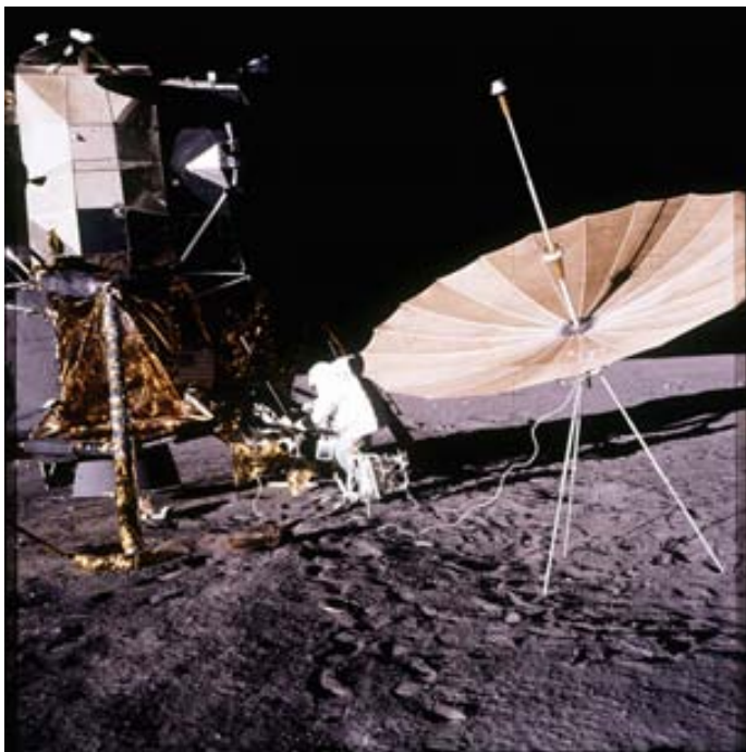
Misión Apolo XII. Vemos con mayor claridad la antena de transmisión de alta ganancia 79 .
