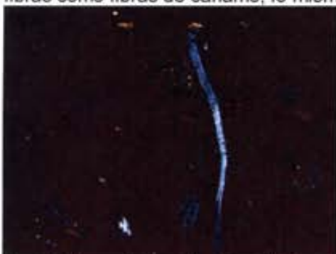
Test de Herzog, Dirección de extinción vertical, 300 X, muestra MS-39
