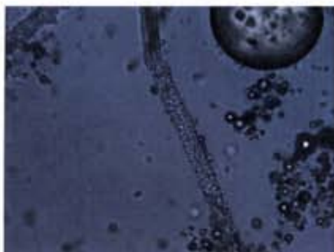
Test de Schweitzer (500 X) sobre la muestra MS-15
