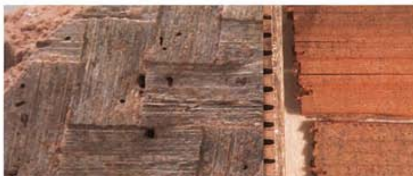
Comparación de las muestras MS-11 con el patrón de palma datilera. La escala central está en mm.
