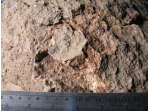
G. Estallido (Bursting) (13,2%) por oxidación de raicillas de líquen ID18
