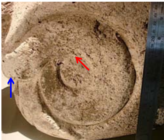
C. Aumento de la Rugosidad (82,1%) ID02. La flecha azul indica el acabado de superficie pulido, la roja el aumento de la rugosidad en la banda enroscada que define los labios en el lateral izquierdo
