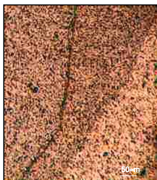
Figura 1.11a Fotografía óptica en el plano ab de fronteras de grano de bajo ángulo para una muestra texturada de YBCO.
