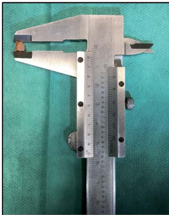
Figura 18. Comprobación con un pie de rey de la medición del segmento óseo resecado de 5 mm, que tras ser procesado se utilizará como aloinjerto óseo.
