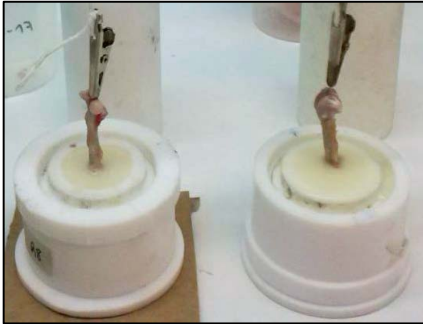
Figura 29. Epífisis inmersa en el cemento dentro del molde de teflón
