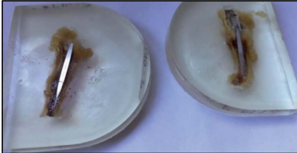
Figura 33. Muestras de fémures de rata cortados, incluidas en resina y pulidas para su evaluación bajo microscopía de fluorescencia.
