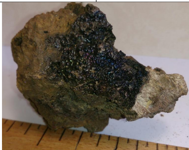
Restes de fusió de mineral amb alteració posterior a goethita (Referència: Pa 3)
