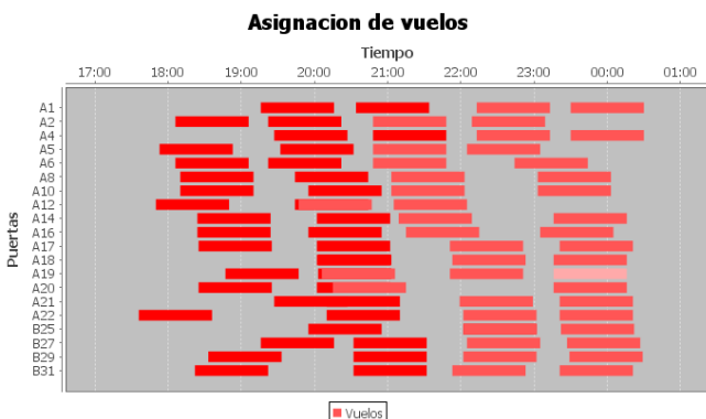
Fig. 3. Gráfico de los resultados obtenidos en la primera llamada al algoritmo de búsqueda tabú.
