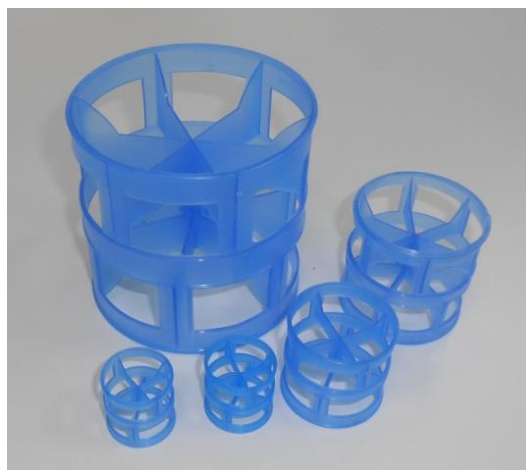
Figura X-11. . Pall Rings de diferent grandàries de diàmetres. Es pot apreciar que són de forma cilíndrica el que facilita també el càlcul del volum amb el seu diàmetre i la seva alçada que són d'un rati de 1:1.
