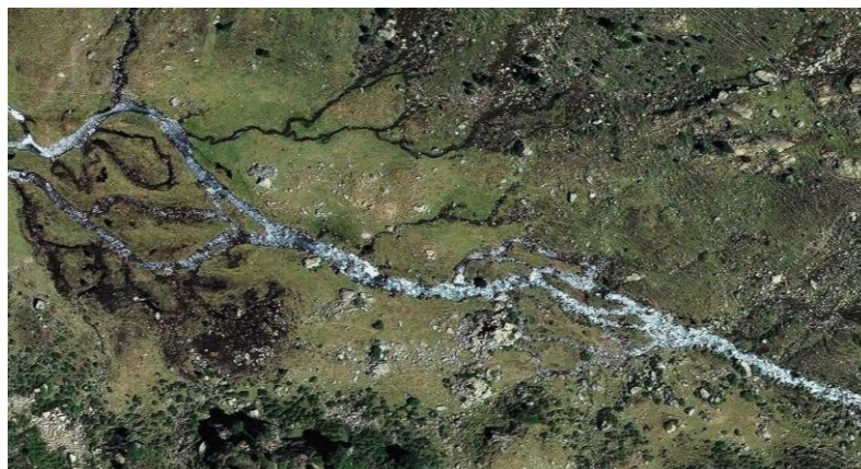
Figura 2.4. Drenatge àcid amb altes concentracions d'alumini.
