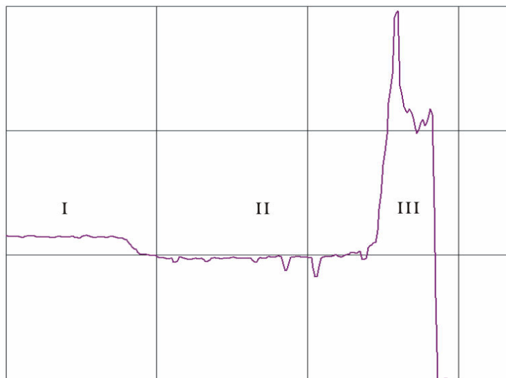
Figura 4.3_3. Corrent detectat amb l'Specimen Current Monitor durant el tall.
