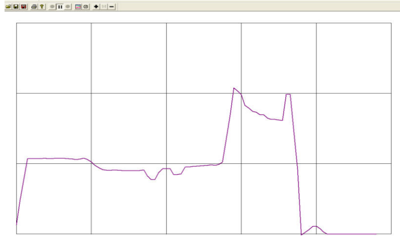
Figura 4.3_4. Corrent detectat durant un tall on s'ha travessat tot el metall.
