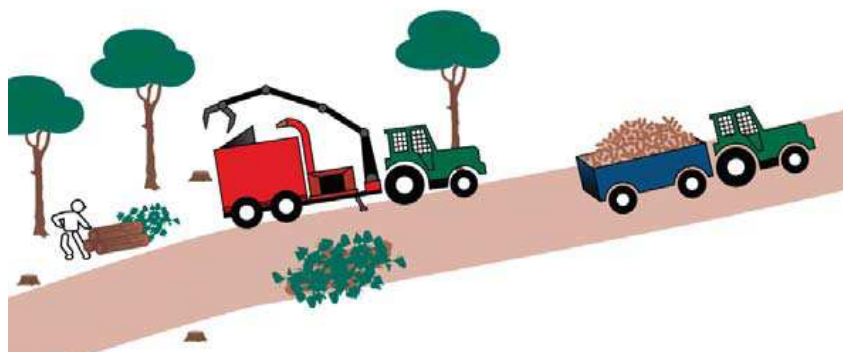
Figura 12.25: Esquema del procés d'estellament mòbil Font: [44].
