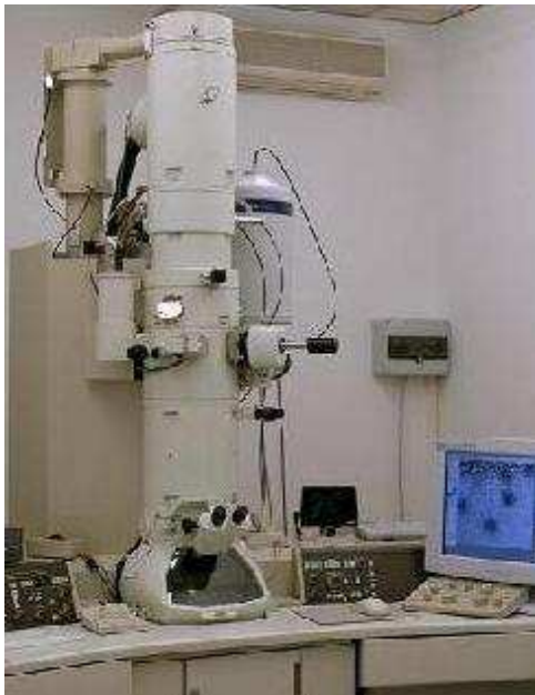
Figura 11. Fotografia HRTEM. Es tracta d'un equip de HRTEM de la marca JEOL, model JEM-2011 que disposa d'un sistema d'anàlisis d'energia de dispersió EDX-INCA.
