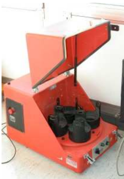
Figura 15. Molí Fritsch Pulverisette 5. S'observa com disposa de 4 zones en el disc per a col·locar-hi quatre vials. En canvi el model P7 només s'hi poden situar dos vials per la mòlta.
