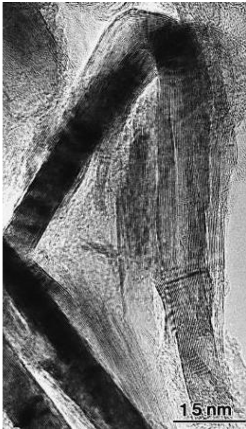
Figura 6. HCCN [6]. En la imatge s'observa com un conjunt de plans de grafit paral·lels (color més fosc) s'han inclinat i formen una HCCN.
