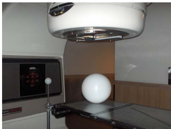
Figura 1.13 Imagen de una de las medidas en una instalación médica (LINAC) con las esferas Bonner, en puntos uno al isocentro y otro a 70 cm
