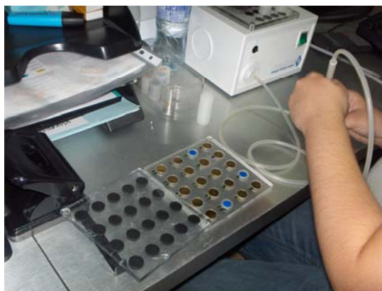
Figura 1.8 Muestra de una colección de láminas de oro utilizados en una medida con el sistema pasivo de esferas Bonner.
