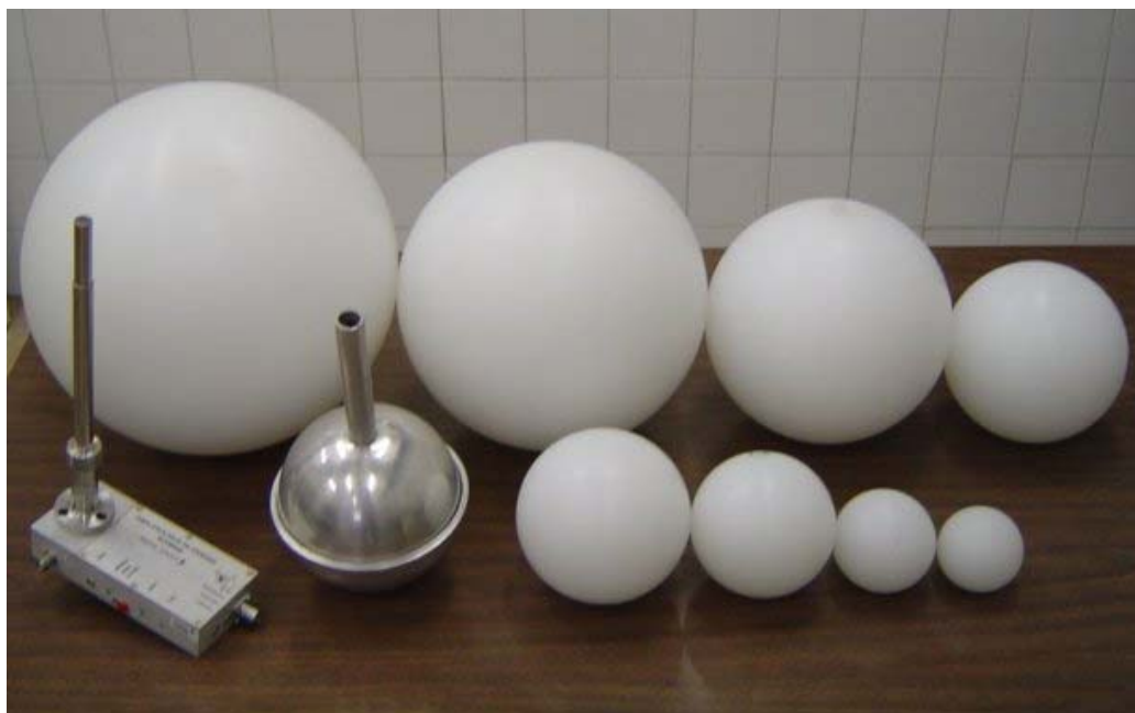
Figura 1.7.- Sistema multiesferas de la UAB formado por 8 esferas de polietileno de diámetros 2.5", 3", 4.2", 5", 6", 8", 10" y 12", con un casquete de 1 mm de Cd en el que pueden introducir las tres esferas más pequeñas, y uno de los contadores proporcionales de ^3\text{He} .
