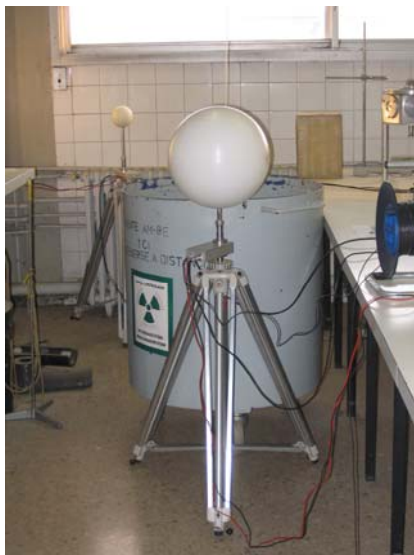
Figura.6.2.- Foto del dispositivo montado para la medida del término fuente
