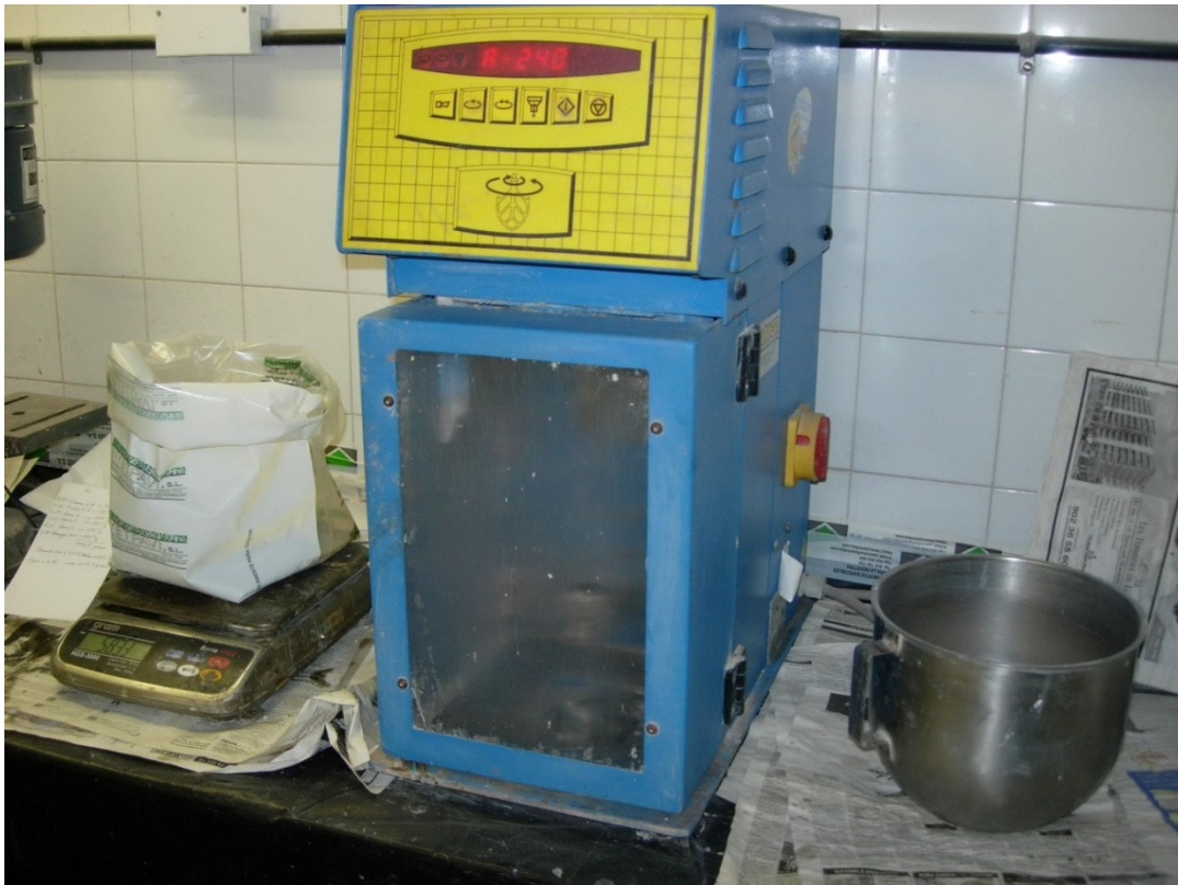
Imagen 4.1.5: Herramientas utilizadas (de izquierda a derecha): balanza, mezcladora y cubeta de mezcladora.
