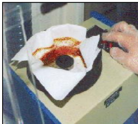
Ilustración 5: deposición de fotoresina en un “Spinner” (máquina de centrifugado)
