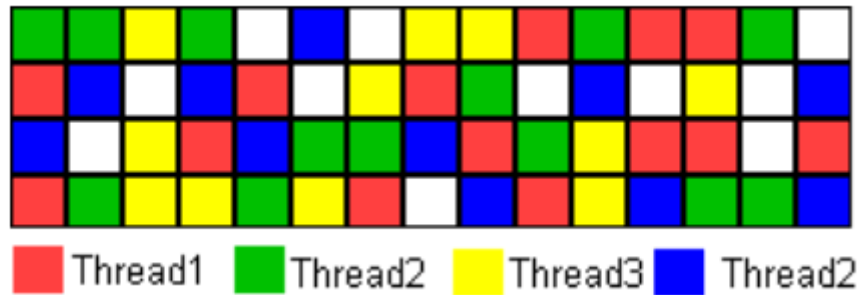
Figura 6 : Ejecución de threads siguiendo el modelo Simultaneous Multithreading.
