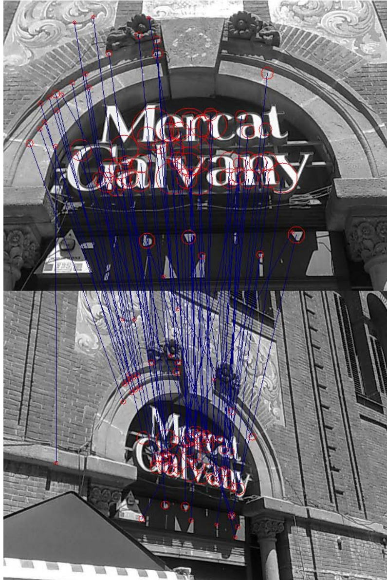
Figura 4.1: Dos imágenes mostrando el cartel de un establecimiento. La figura de arriba se toma como referencia mientras que la de abajo ha sufrido una transformación de escala y de punto de vista. Los círculos indican que un punto ha encontrado coincidencia en la otra imagen. El tamaño del círculo indica la escala del punto. Con líneas azules se unen las parejas de puntos coincidentes. Las coincidencias han sido obtenidas utilizando vecino más cercano.
