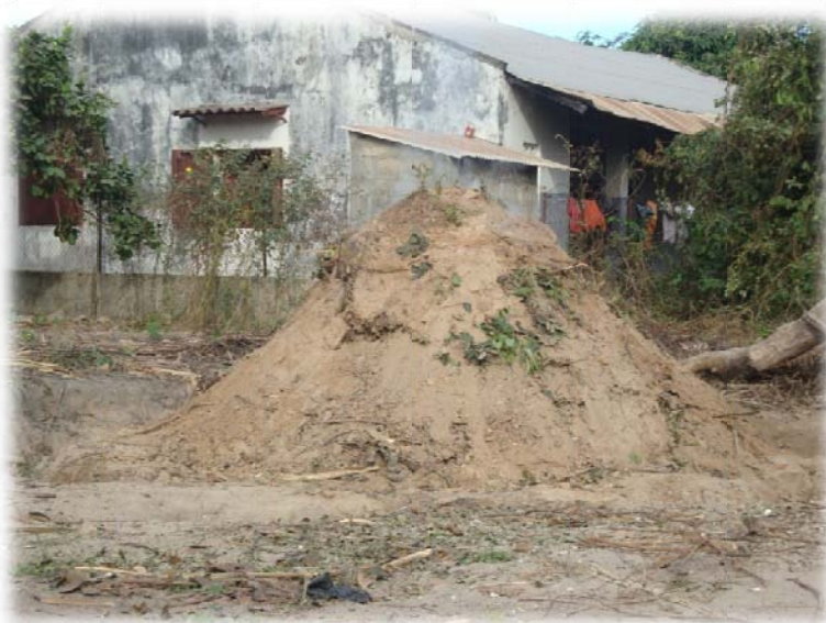
Fig. 1.34: Pila de llenya tapada amb fulles i sorra, per fer carbó. Font: Llongueras, M., Nicart, M.
