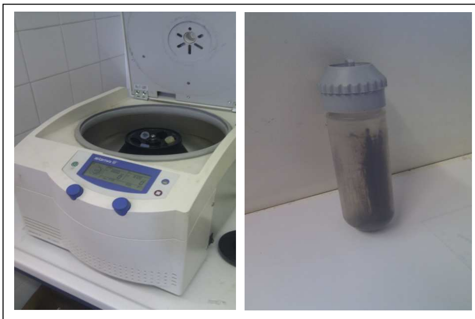
Figuras 26 y 27: Imagen de la centrifugadora utilizada (izquierda), y del tubo de centrifuga, donde se observa la plata pegada en la pared del tubo después de la centrifugación del crudo de reacción correspondiente a la síntesis del precursor L2 (derecha).
