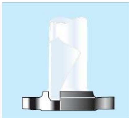
Figura 4.1.4 Brida con asiento para soldar
