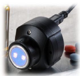
Figura 7.- Imatge de l'espectrofotòmetre NIR en miniatura desenvolupat per JDSU.
