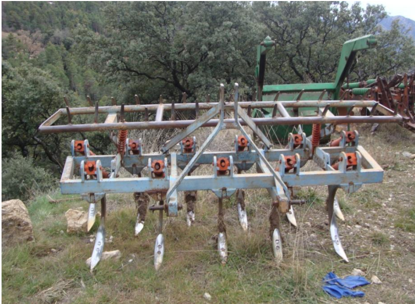
Imatge 11. Arada mecanitzada, la qual s'enganxa al tractor per realitzar l'obertura del terreny
