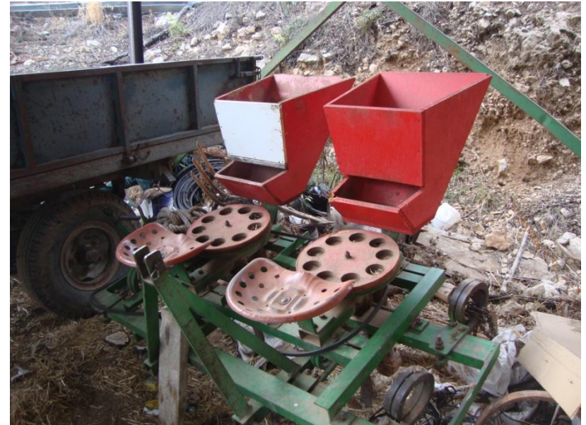
Imatge 12. Maquinària emprada per la distribució de llavors al sòl. Disposa d'una sortida inferior on s'alliberen les llavors que s'han introduït en els dipòsits vermells.
