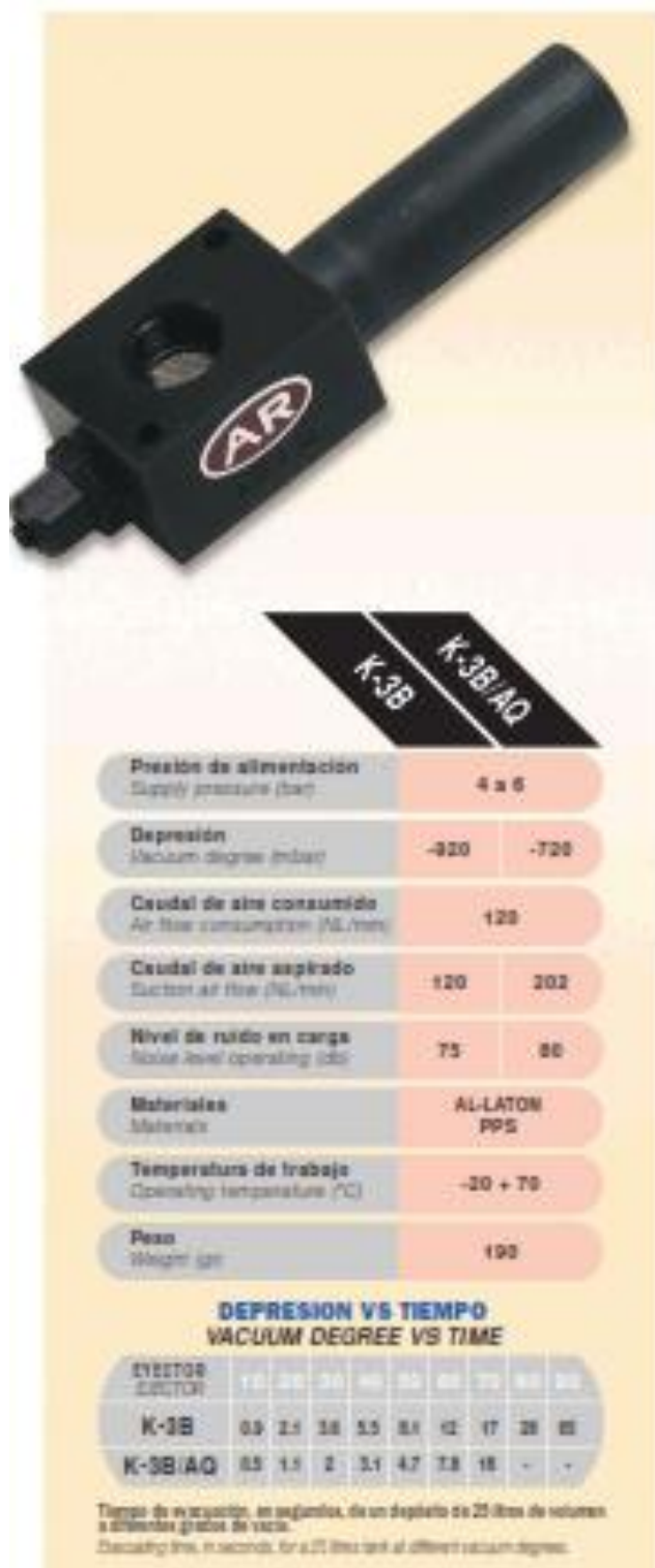
Figura 11.2.13.. Especificaciones técnicas del eyector K-3B
