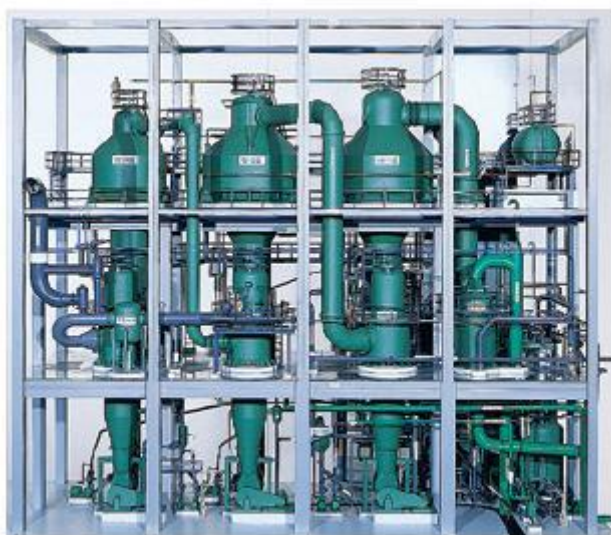
Figura.11.9.5. Cristalizador evaporativo de triple efecto.
