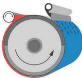
Figura 11.11.2. Esquema simplificado del funcionamiento de una escamadora KBO
