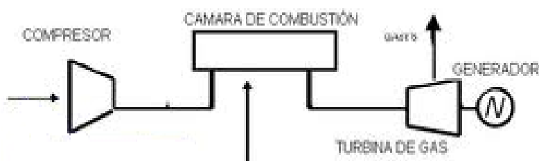
Figura 12.1.1 Esquema de una turbina de gas
