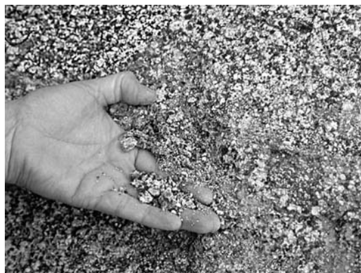
Fig. 2.- La descomposición "in situ" del granito en un clima mediterráneo da lugar a una arena gruesa o muy gruesa, conocida en Cataluña con el nombre local de "sauló".
