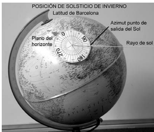
Fig. 11. Ejemplo medición del azimut de la salida del Sol en la posición de solsticio de invierno, para la latitud de Barcelona.
