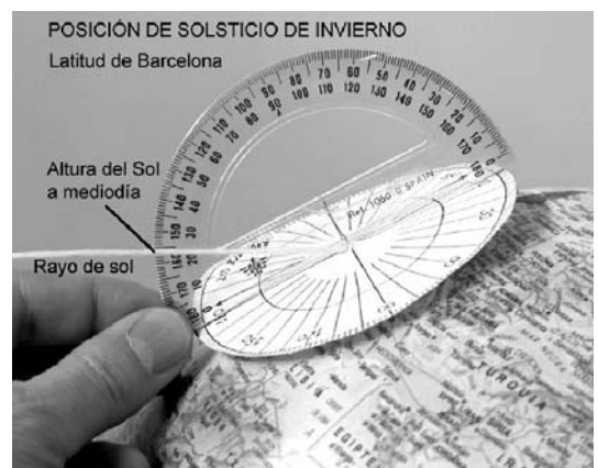
Fig. 12. Ejemplo medición de la altura del Sol a mediodía en la posición de solsticio de invierno, para la latitud de Barcelona.
