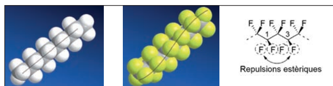
FIGURA 1. Conformació en ziga-zaga del deca i conformació helicoidal del perfluorodeca.
