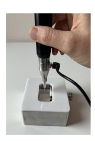
**Figure 4.** Hand microindenter (Osteoprobe<sup>®</sup>).
