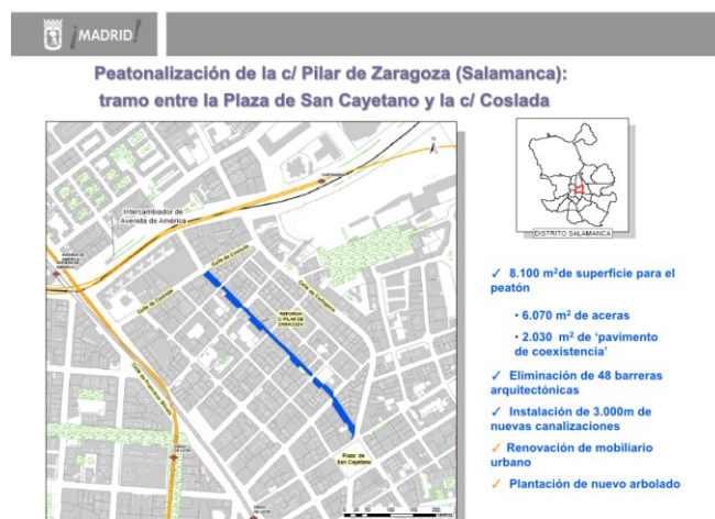
Fig.5. Propuesta de reurbanización de la calle Pilar de Zaragoza presentada por el Ayuntamiento al vecindario, en la que se muestra la nueva sección y el reparto del espacio público proyectado. La intervención se sitúa en el origen de una etapa de movilización vecinal en torno a las transformaciones urbanas del barrio
