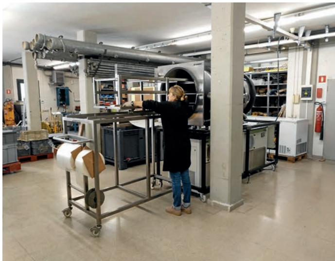
Fig.18. Liofilitzador del Centre d'Arqueologia Subaquàtica de Catalunya on es restauren una bona part dels materials amarats recuperats.
