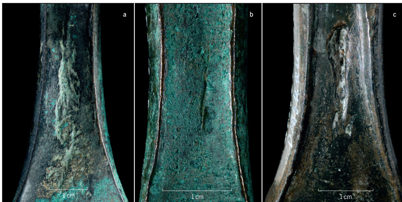
Abb. 11a–c Einige Beile (von links: HK 37:18l, 55, 71 und 290) weisen auf einer oder beiden Seiten in der Bahn eine längs verlaufende, unregelmäßige »Rille« von unterschiedlicher Stärke auf. Sie zeigt in den meisten Fällen noch die Oberflächenstruktur des gegossenen Rohlings. Der Grund ist, dass die alte Oberfläche beim seitlichen Überschmieden noch nicht komplett von dem zur Mitte hin geschmiedeten Material überwachsen wurde.
