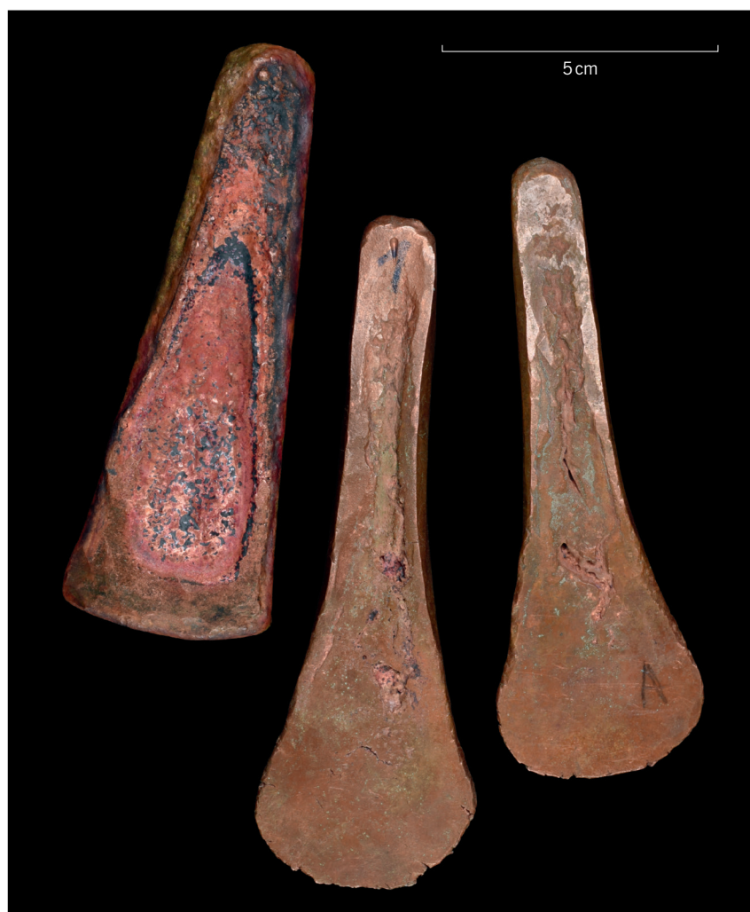
Abb. 12 Mitte und rechts: Zwischenstände eines Versuchs, Randleistenbeile aus einem gegossenen Rohling (links) zu schmieden. Man sieht, dass die rohe Gusshaut in der Mitte des Schaftes erhalten bleibt und wie die in den Beilen anzutreffende tiefe »Rille« in der Bahn entsteht.
