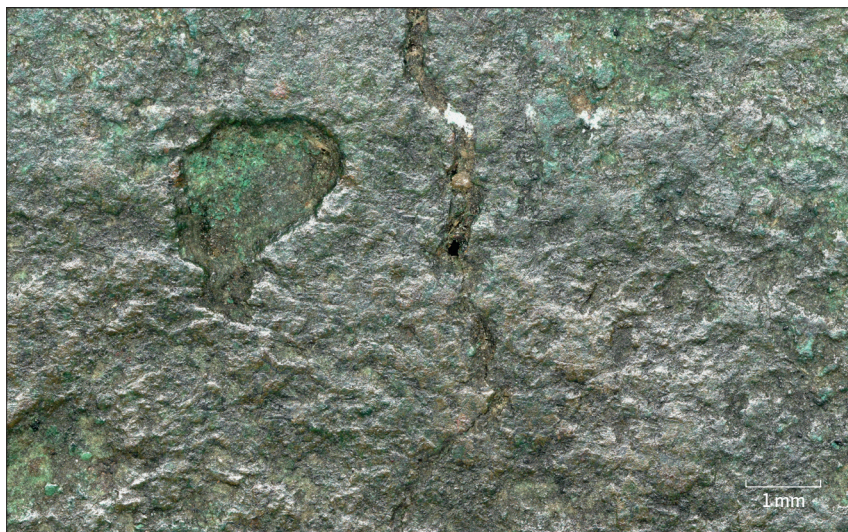
Abb. 18 Burgstaden-Milzau, Saalekreis. Mikroskopische Aufnahme. Quer durch das unregelmäßig geformte mutmaßliche Halbfabrikat zieht sich ein »Ermüdungsriß«, der wohl von unsachgemäßem Schmieden verursacht wurde.
