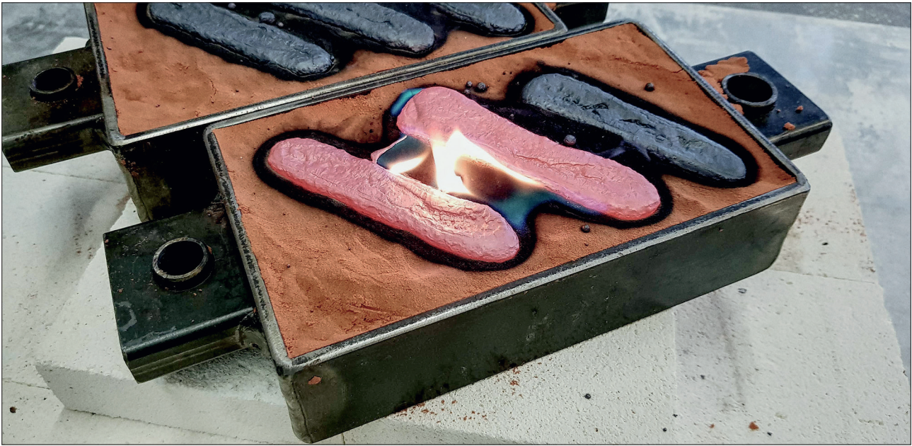
Abb. 13 Gussversuch in offener Form. Beim Erstarren bildet sich eine wellige Oberfläche, wobei sich infolge von Erstarrungskontraktion das Metall in der Mitte konkav zusammenzieht. Oftmals bilden sich schon hierbei längs verlaufende tiefe Spalten aus.
