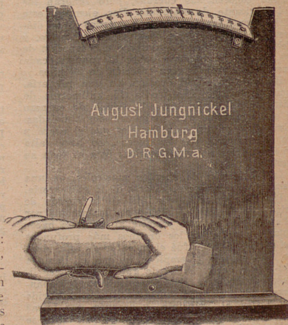
Fig. 4.—Aparatos para calibrar toda clase de tripas, escala de 0 a 80 milímetros.
