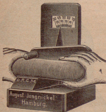
Fig. 6.—Aparato para calibrar tripas de vacuno, de 30 a 70 milímetros.
