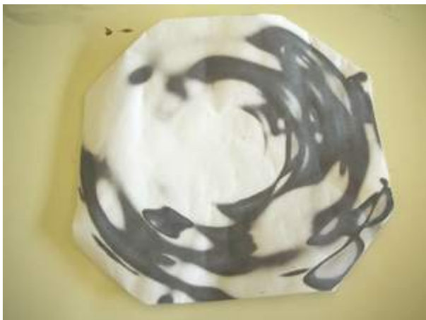
Figura 3. Ennegriment del paper de fax quan gira el plat
