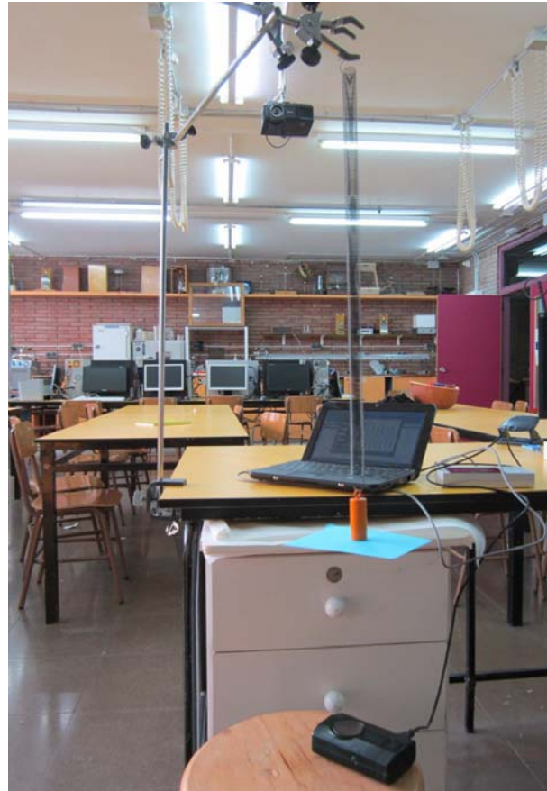
Figura 5. Muntatge de la molla amb la massa i el paper per friccionar amb l'aire.
