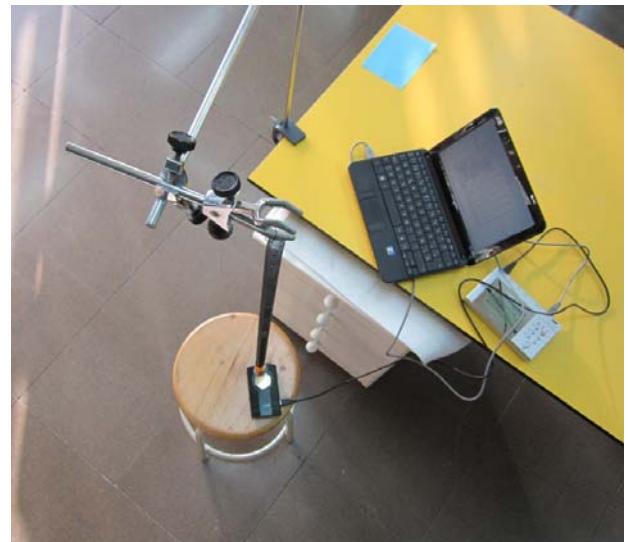
Figura 3. Muntatge de la molla amb la massa i el sensor de moviment a sota.
