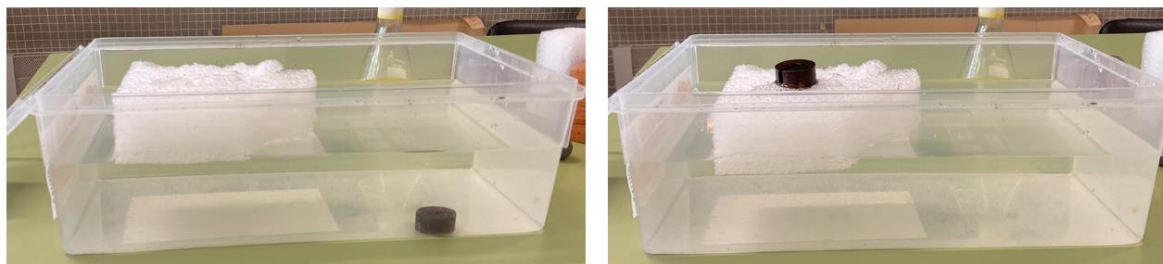
Figura 3. a. (esquerra) La peça (major massa) i el suro (menys massa) per separat. b. (dreta) La peça i el suro junts floten.
