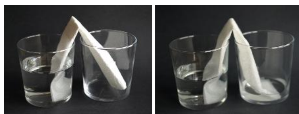
Figura 4. Desplaçament de l'aigua en dos vasos iguals (un amb aigua i l'altre sense) connectats amb un pont de paper de cuina. A l'esquerra, situació inicial. A la dreta, situació al cap d'una estona.
