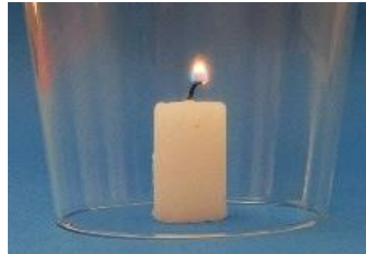
Figura 4. Dins el vas, la flama es va apagant per falta d'aire.
