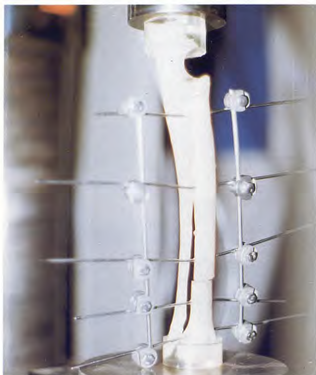
Fig. 4. Deformación total de las agujas. Las barras conectoras no muestran ningún tipo de alteración.
